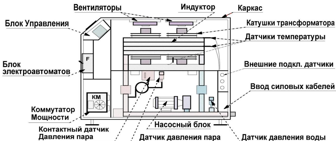
Рис. 1 Состав парогенератора с одним индуктором.
