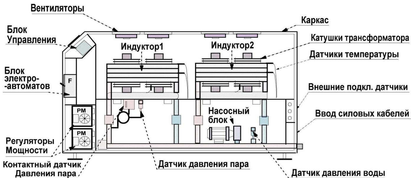
Рис. 2 Состав парогенератора с двумя индукторами.
